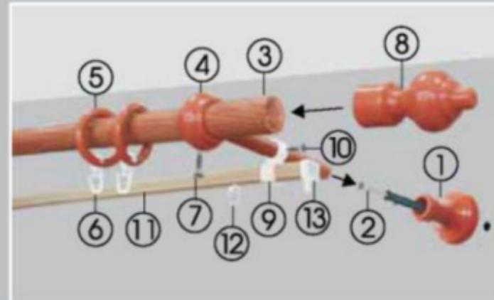
1. Разметить и просверлить отверстия в стене.
